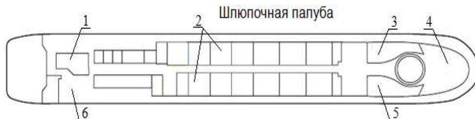
Рис. 1. Схема размещения крытого плавательного бассейна на теплоходе проекта Q-056: 1 – ванна бассейна; 2 – каюты; 3 – бар «Кострома»; 4 – музыкальный салон; 5 – TV-салон; 6 – бар.
