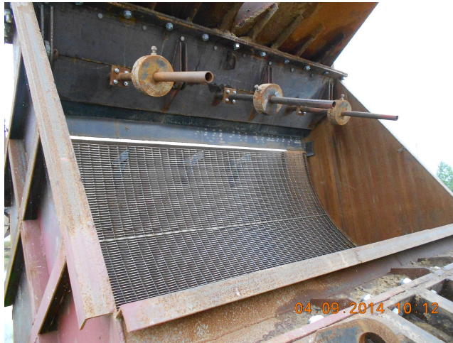
Рис. 3. Сито с поперечным расположением колосников
