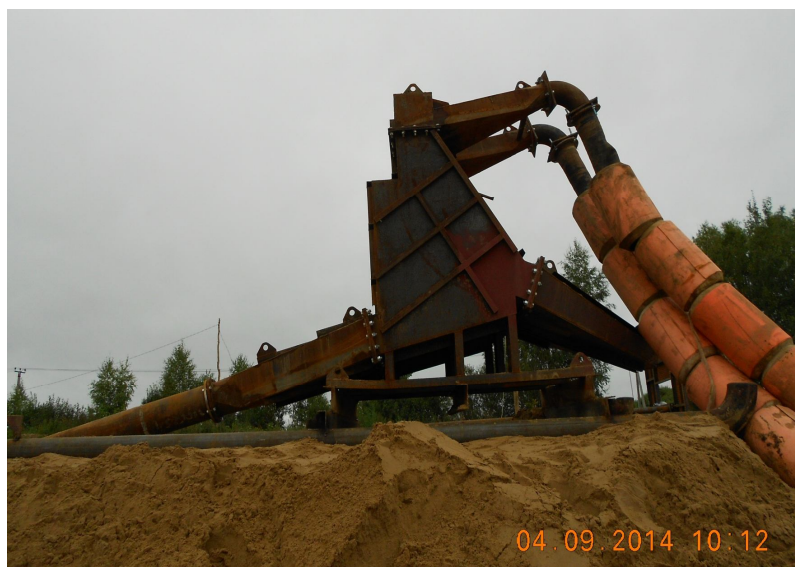
Рис. 4. Дуговой гидрогрохот с расходом водогрунтовой смеси 800–1000 м 3 /ч
