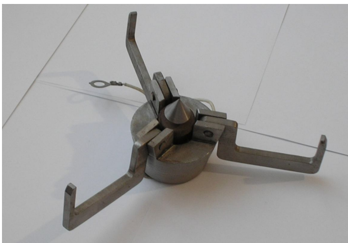
Рис. 3. Общий вид экспериментального образца двухдеформационного съемника
