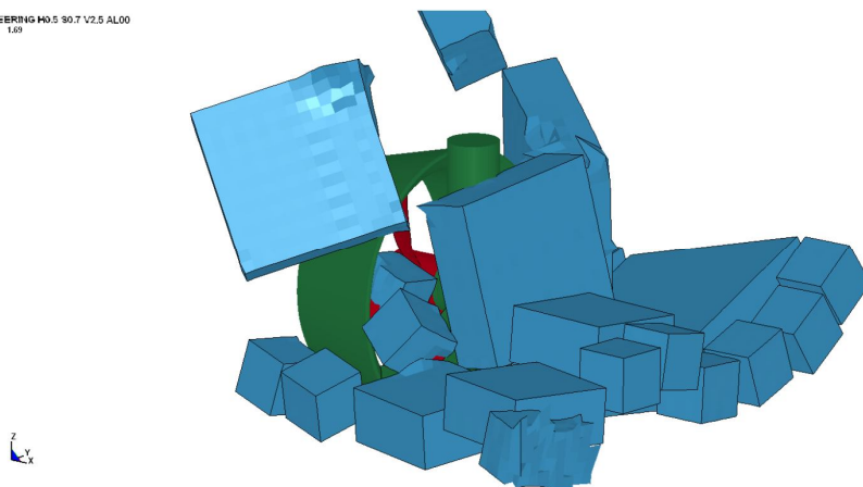
Рис. 8. Характер взаимодействия ВРК с тёртыми льдами
