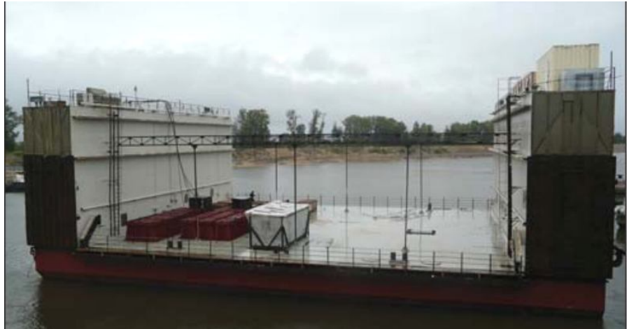
Рис. 4. Блок-модуль дока пр. 28140 перед отправкой на морскую достроечно-сдаточную базу
