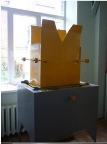
Рис. 2. Конструкция бункера с изменяющейся вместимостью
