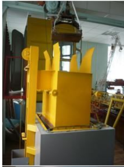
Рис. 2. Конструкция бункера с изменяющейся вместимостью
