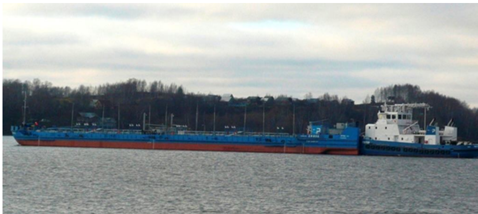
Рис. 3. 2010 год. Толкаемый состав «река-море» плавания выходит из заводской гавани на ходовые испытания
