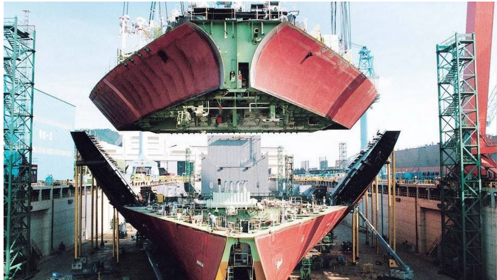
Рис. 2. Процесс установки блока на корпус Заказа
