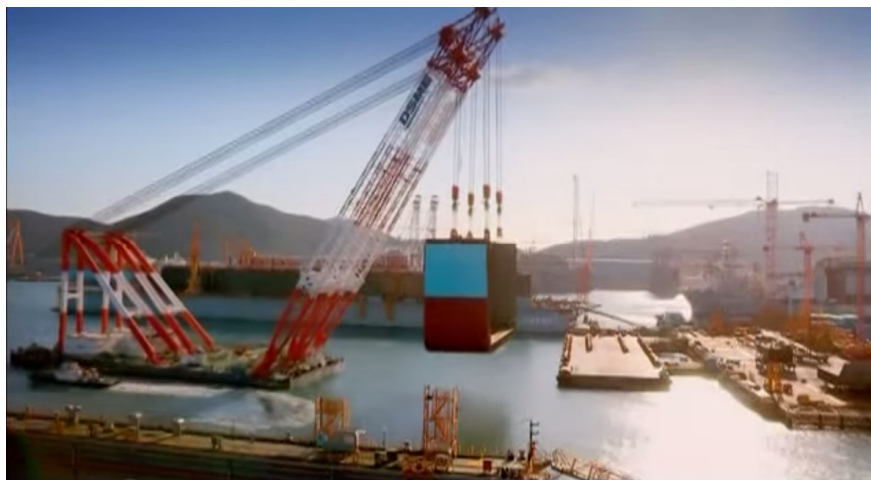
Рис. 3. Применение плавкрана для транспортировки блоков в док-камеру (Верфь DSME расположенная на о-ве Кодже, Корея)
