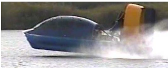
Рис. 2. Отрыв АСВП от поверхности воды на скорости 110–115 км/ч
