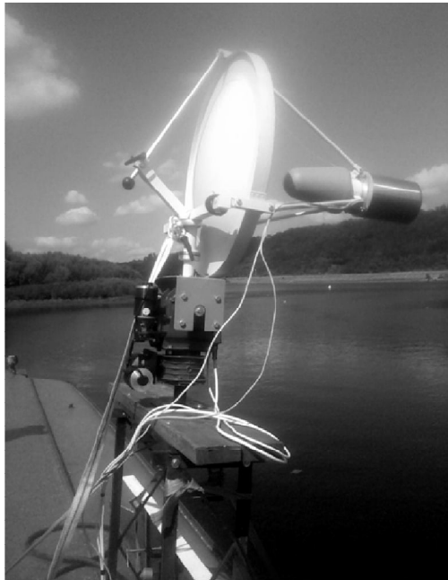
Рис. 1. Многочастотный радиолокатор X-/C-/S-диапазонов на борту исследовательского судна «Петр Андриянов»
