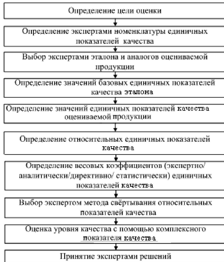
Рис. 1. Алгоритм квалиметрической оценки качества объекта
