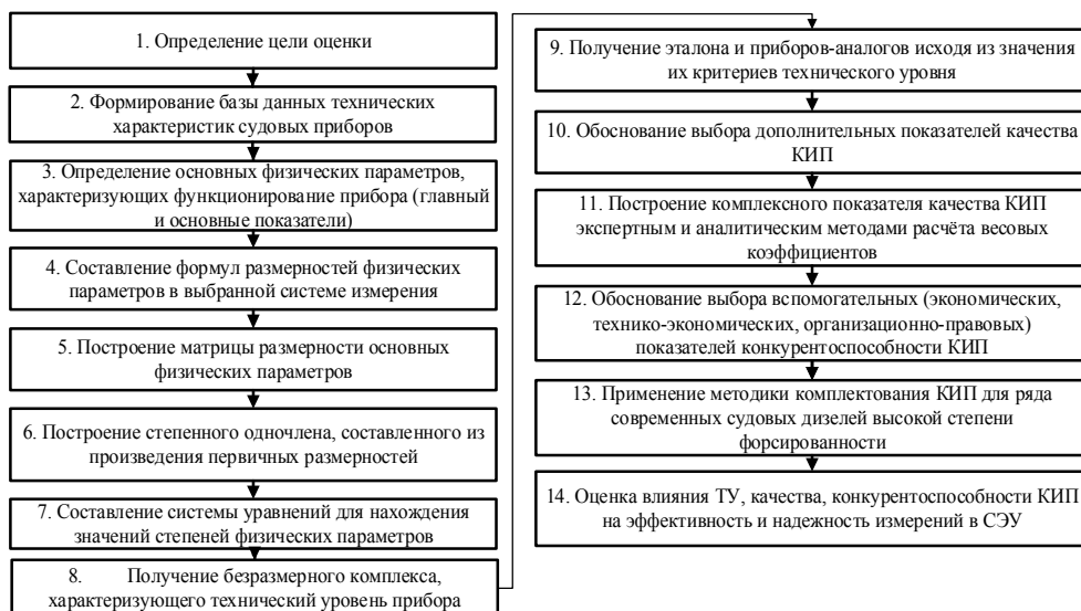
Рис. 2. Алгоритм комплектования КИП СЭУ с учётом их технического уровня, качества и конкурентоспособности
