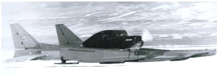
Рис. 4. ЭП «Орфей» (АДП-05) на испытаниях над ледовой поверхностью
