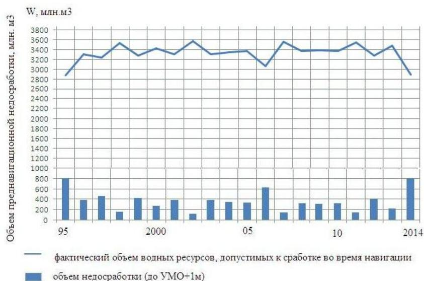
Рис 5. Дополнительный объем водных ресурсов Воткинского водохранилища, допустимых к использованию во время навигации
