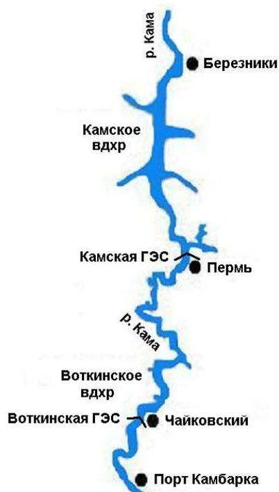
Рис. 1. Схема расположения Камского и Воткинского гидроузлов и водохранилищ на реке Кама
