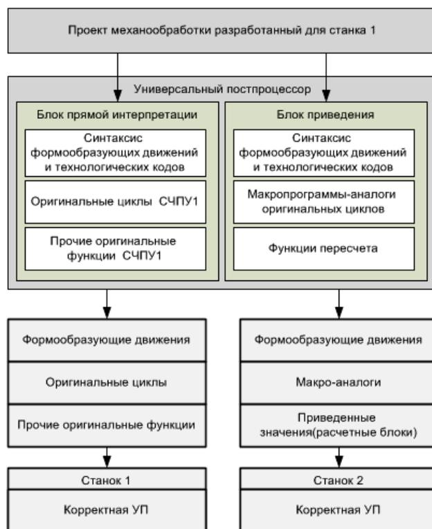
Рис. 2. Алгоритм формирования УП универсальным постпроцессором
