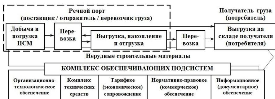
Рис. 5. Транспортно-логистическая система добычи и поставки нерудных стройматериалов речными предприятиями
