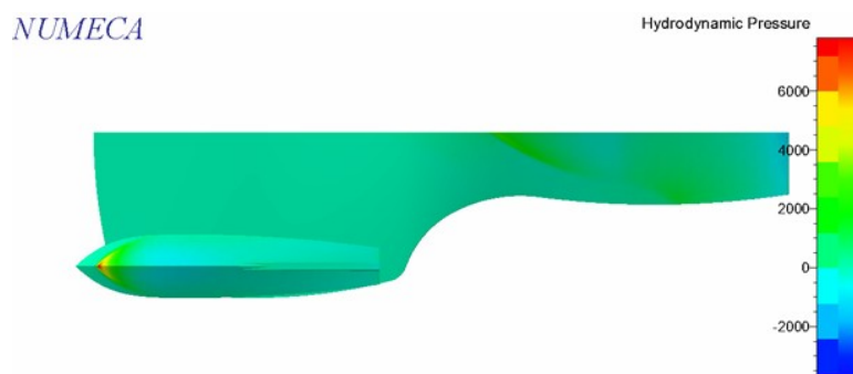
Рис. 8. Распределение гидродинамического давления по поверхности корпуса катера: а) глиссирующие поплавки; б) водоизмещающие поплавки
