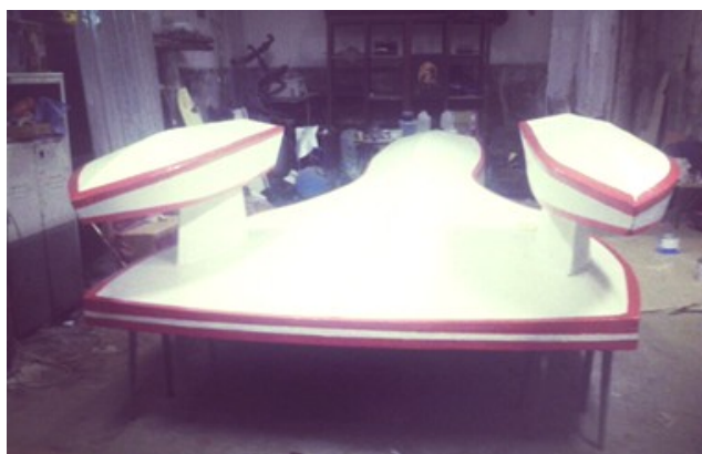
Рис. 1. Катер на солнечных батареях с установленными глиссирующими поплавками
