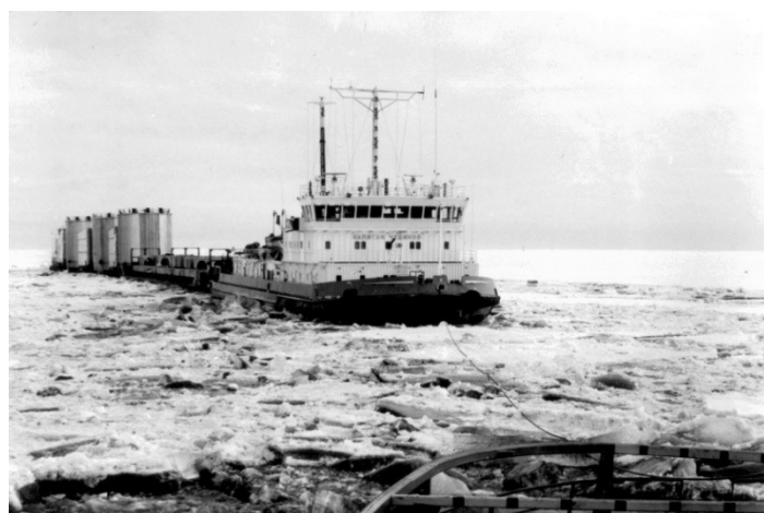
Рис. 4. Качественное состояние ледового канала за ледоколом проекта 1191 (а, б – толщина льда 0,4–0,6 м; в, г – толщина льда около 1,5 м)
