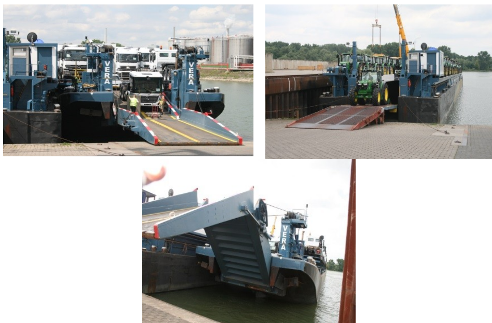
Рис. 2. Судно с горизонтальной грузообработкой, предназначенное для перемещения автопоездов, контейнеров и любых видов генеральных грузов по внутренним водным путям
