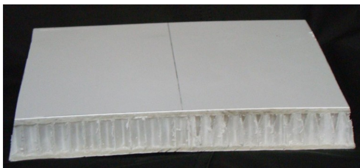
Рис. 6. Элемент конструкции надстройки с легким армированным средним слоем на базе заполнителя nidaplast
