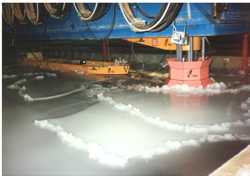
Рис. 4. Модельные испытания системы «СМЛОП – танкер» в ледовом бассейне Хельсинского технологического университета
