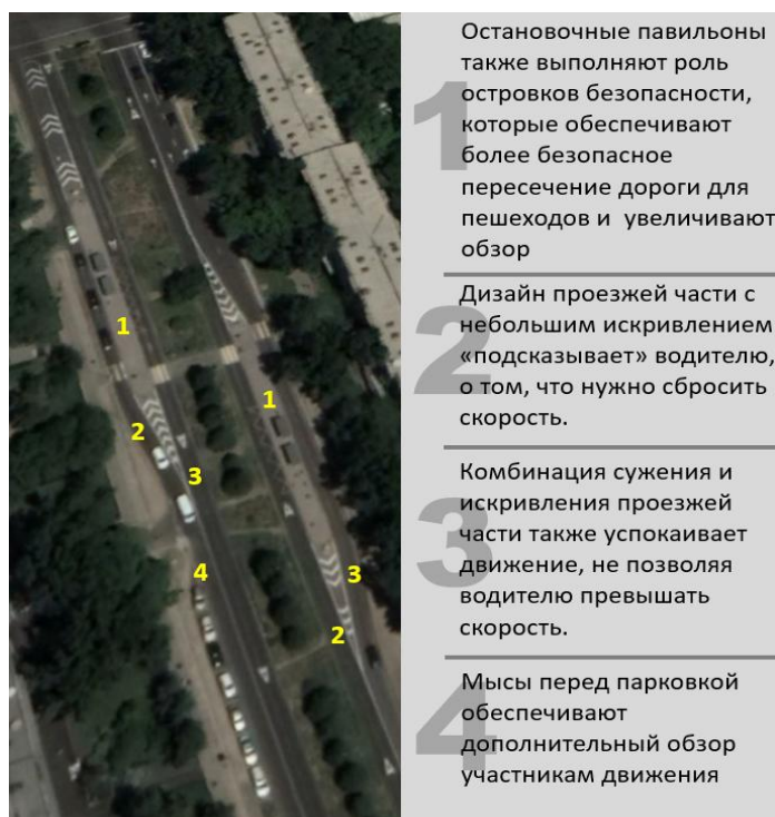
Рис. 4. Изменение дизайна проезжей части на улице Мустафина (у пересечения с ул. Торайгырова) с учетом создания коридора BRT.
