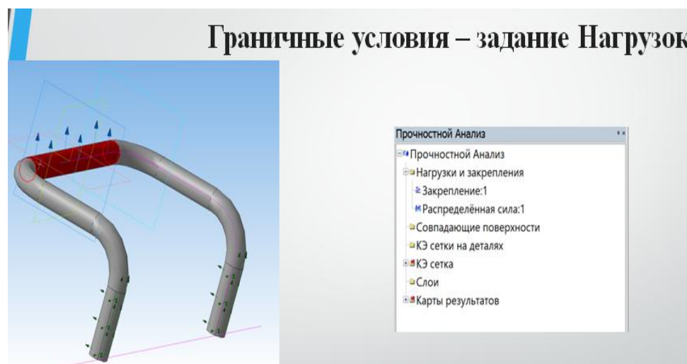
Рис. 3. Результат приложения нагрузок и закрепления к технической поверхности
