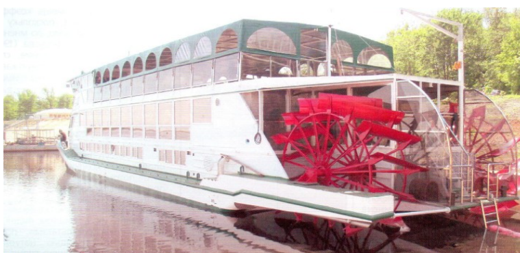
Рис. 2. Судно «Сура-2», оборудованное кормовыми колесами с неповоротными плицами
