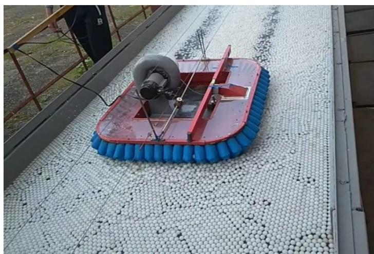
Рис. 8. Фрагмент испытаний модели ЛПВП в гранулах полиэтилена
