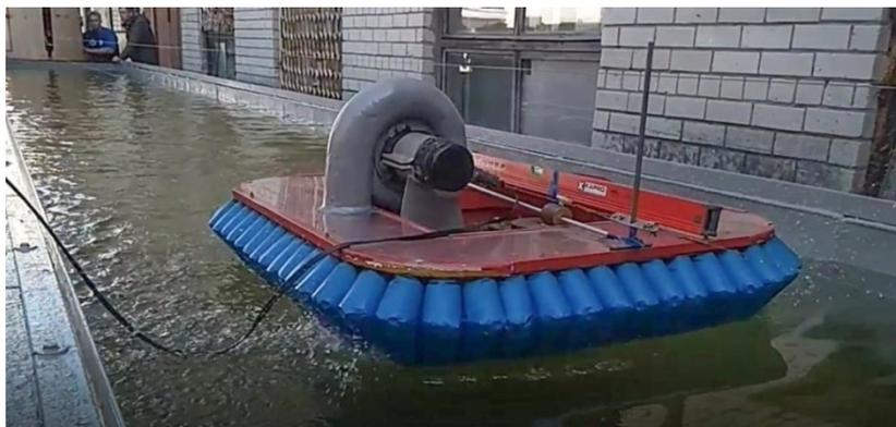
Рис. 6. Фрагмент испытаний модели ЛПВП на чистой воде
