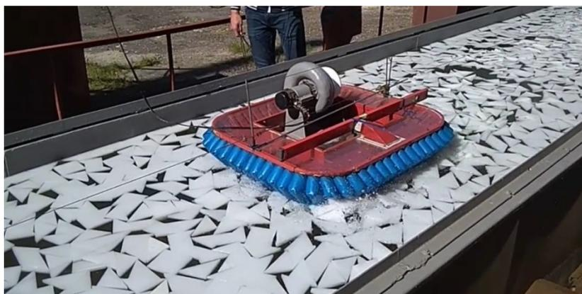
Рис. 7. Фрагмент испытаний модели ЛПВП в треугольных плитках полиэтилена
