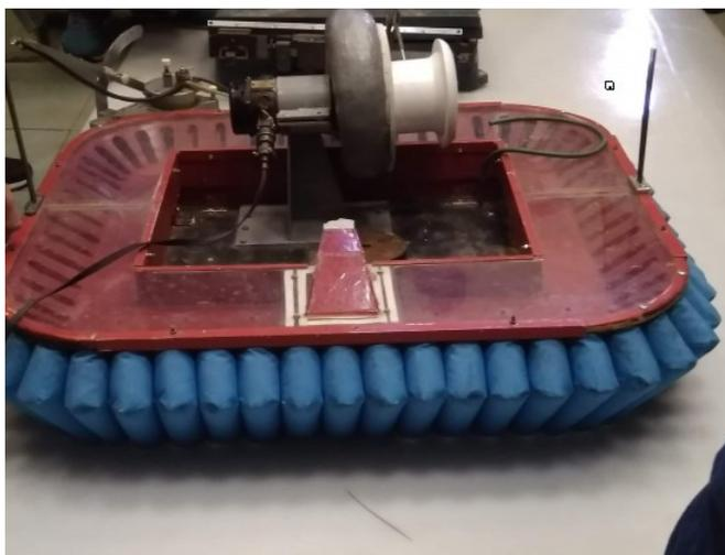
Рис. 2. Модель при испытаниях над твердым экраном
