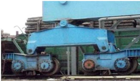
Рис. 23. Соединение опоры с балансиrom
