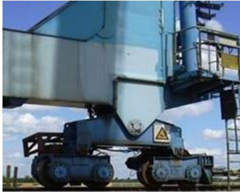
Рис. 22. Соединение опоры с балансиrom
