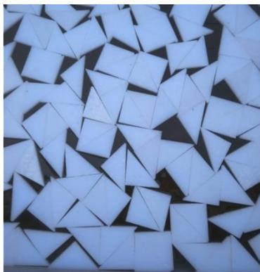
Рис. 3. Треугольные плитки полиэтилена 20×100×100 мм
