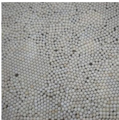
Рис. 4. Шарики полиэтилена диаметром 20 мм
