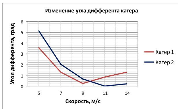
Рис. 10. Изменение угла дифферента двух вариантов корпуса катера
