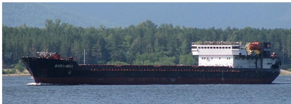
Рис. 1. Общий вид сухогрузного теплохода типа «Волга» проекта 19610
