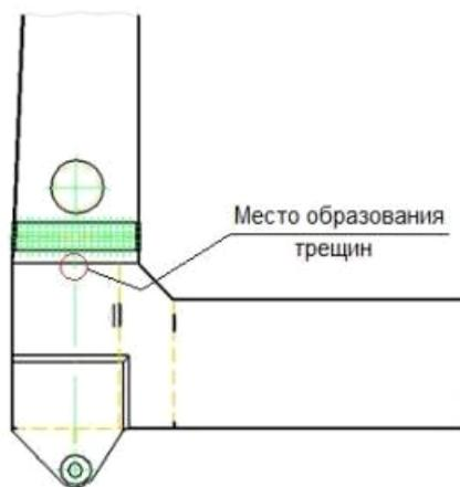
Рис. 11. Место образования трещин в жесткой опоре
