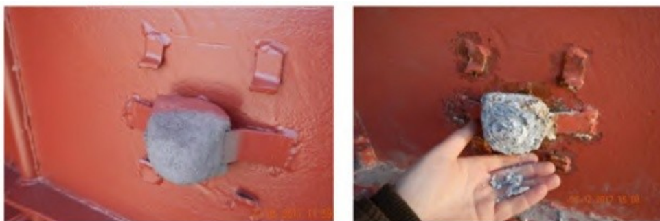
Рис. 3. Протектор в начале эксплуатации (слева) и в конце срока службы (справа) [11]
